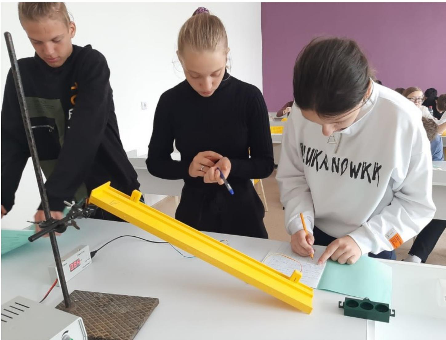
Лабораторная работа по физике в 9 классе по теме: «Исследование равноускоренного движения без начальной скорости»
